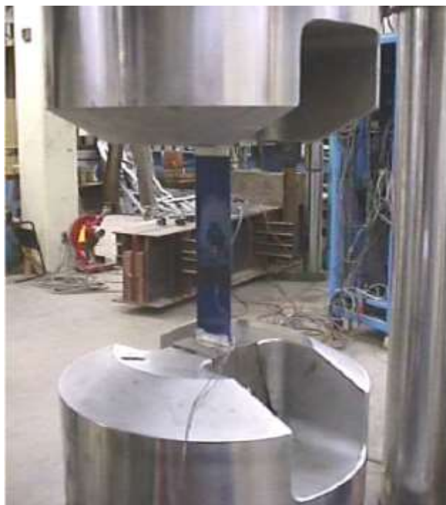
Esecuzione del test secondo ASTM D3039
